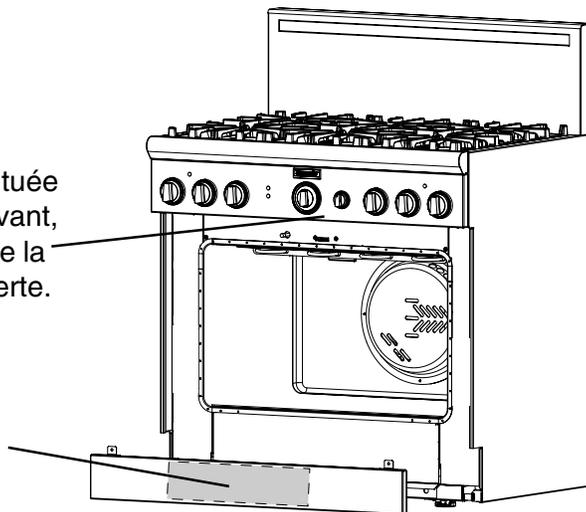
Emplacement plaque signalétique et diagramme de câblage (porte du four non illustrée)
